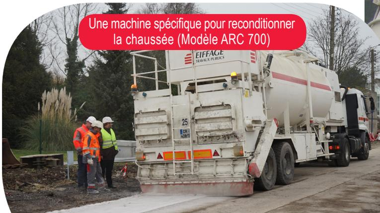
Une machine spécifique pour reconditionner la chaussée (Modèle ARC 700)
